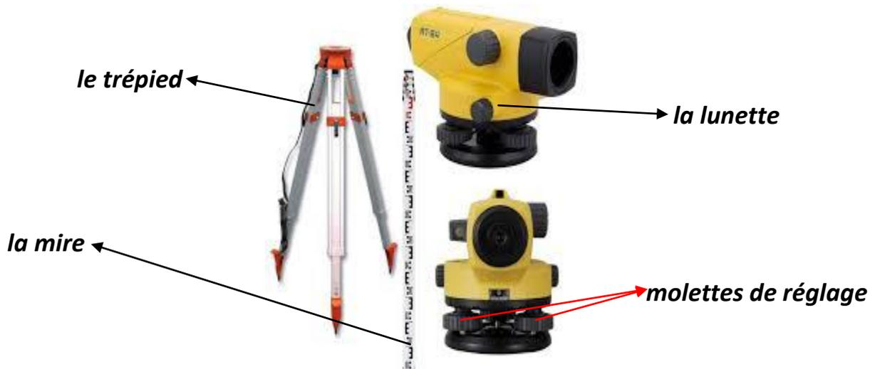
*Il s'agit d'un appareil de précision permettant de reporter des points de niveau.*
