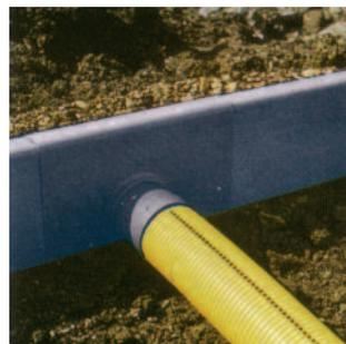
L'**élément de raccord FSD** sert à raccorder un drain tubulaire DN100 afin d'assurer l'écoulement des eaux vers son évacuation. Il est important de prévoir au minimum une évacuation tous les 20 m.
