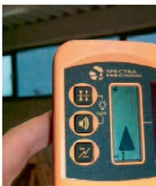
La position du récepteur peut aussi être signalée par un signal sonore. Celui-ci peut être activé ou désactivé à l'aide de la touche 2 du récepteur.
