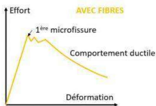
*Apport des fibre sur le comportement post fissuration du béton.*
