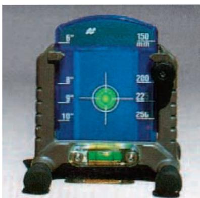
Ce laser s'utilise donc avec une plaquette de réception. Cette dernière est placée dans la partie inférieure de la canalisation. Sur la plaquette figure une mire qui reçoit le rayon du laser et permet de voir clairement si la canalisation se trouve trop haut ou trop bas, ou si la direction doit être corrigée.
