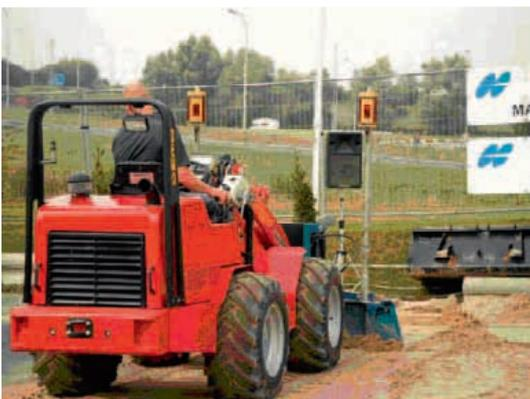
Des modèles encore plus perfectionnés permettent même un pilotage automatique de l'engin : l'opérateur n'a plus qu'à suivre la bonne direction (bulldozers, niveleuses, lame niveleuse, etc.)
