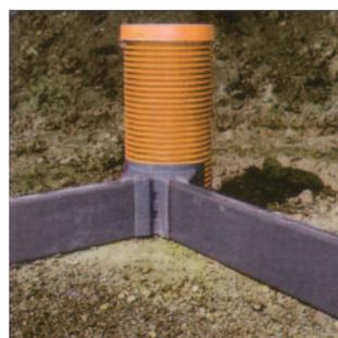
Le **puits de rinçage et de contrôle FSD** augmente la sécurité du drainage. Il permet un contrôle simple ainsi que le rinçage du système de drainage sur toute sa longueur. Les rehausses des puits **FSD** permettent de rehausser les puits selon la profondeur de construction du système de drainage.
