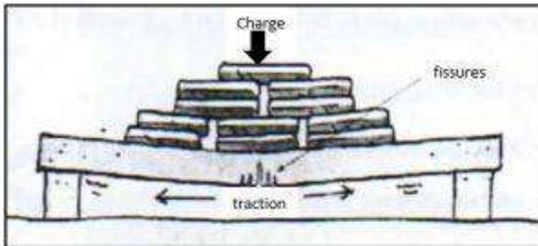
*La poutre en béton non armé est peu résistante.*
