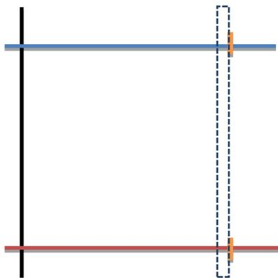
Il ne te reste qu'à placer une règle métallique le long des deux points, et tracer un trait, (le dernier coté de ta chambre de visite) place maintenant l'équerre dans chaque coin afin de vérifier l'équerrage.
