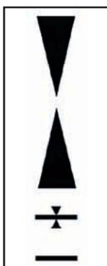
→ le récepteur est plus haut que le rayon laser et doit être descendu
